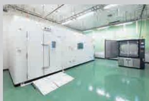
①大型環境試験室
